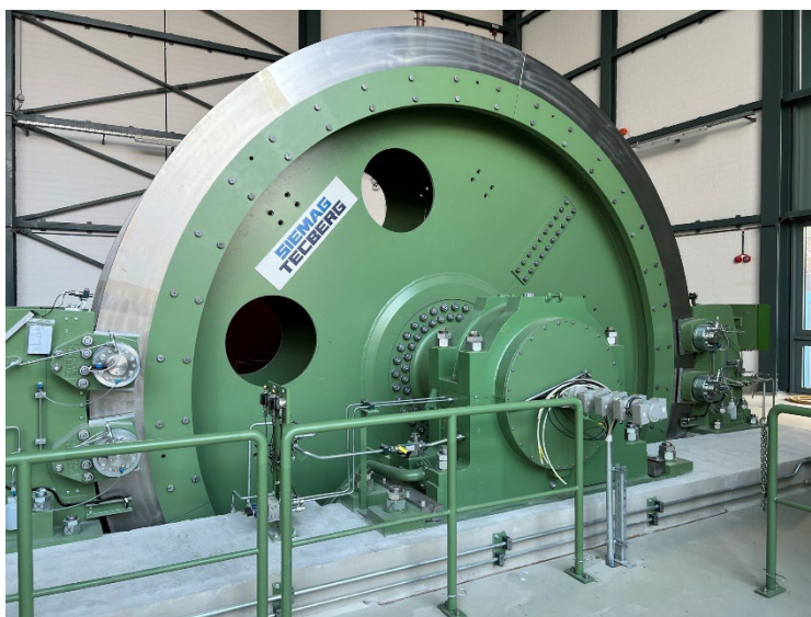
Fig. 6-5: Fördermaschine der neuen Schachtförderanlage bei Schacht Konrad
