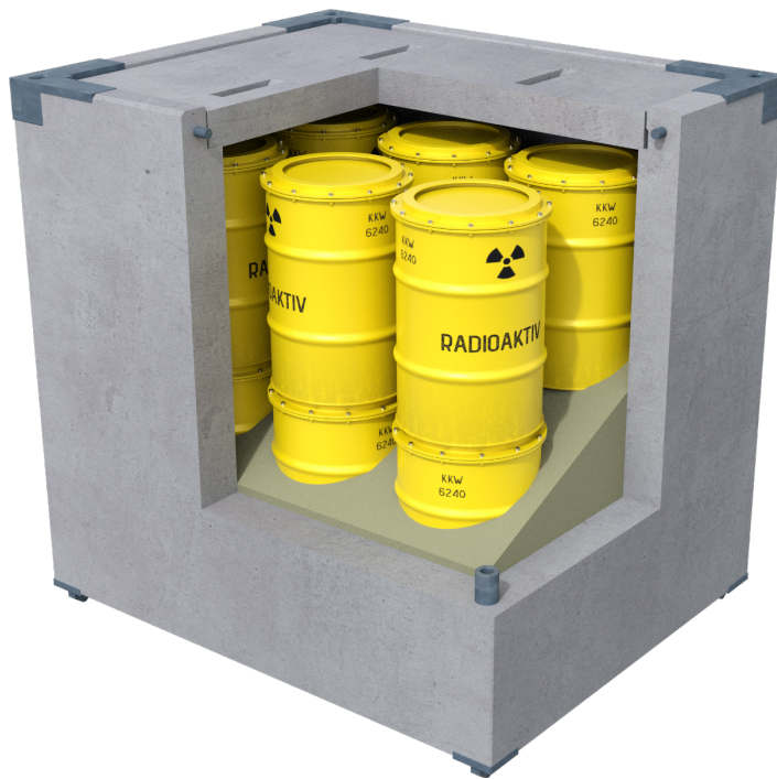
Fig. 3-6: Endlagerbehälter mit SMA Modellhafte Darstellung eines befüllten SMA-Endlagerbehälters
