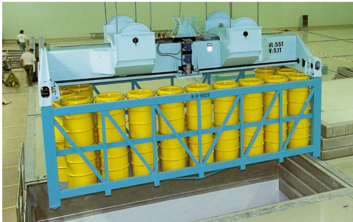
Fig. 3-5: Zwischenlagerbehälter mit SMA Gitterbox (Zwischenlagerbehälter) mit mittelaktiven Abfällen (in 200-Liter-Fässern); Bild: Zwilag
