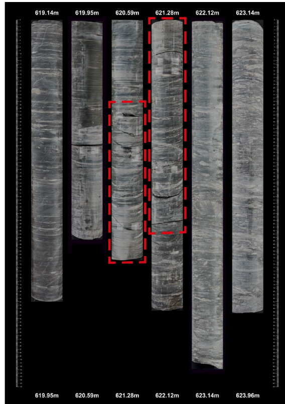
Fig. 4-9: Beispiele von in den TBO angefahrenen Störungszonen des Typs I in wenig kompetenten Gesteinseinheiten (MAR1-1 Bohrmeter 620.9 – 621.9)
