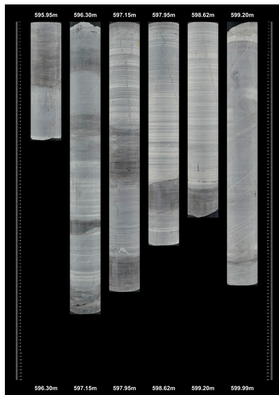
Fig. 3-6: Kernbeispiel der Villigen-Formation aus STA3-1
