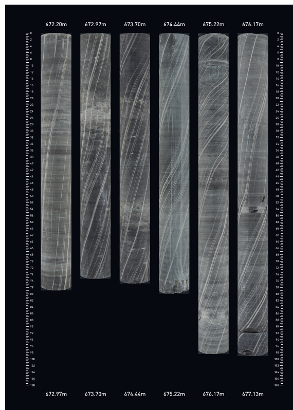
Fig. 3-7: Kernbeispiel der Wildegg-Formation aus STA3-1
