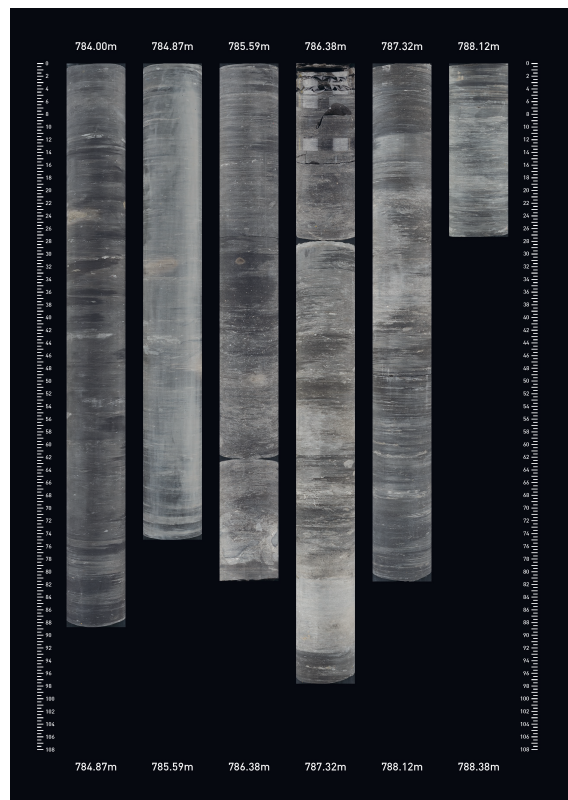
Fig. 3-11: Kernbeispiel des Opalinustons aus STA3-1
