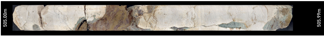
Fig. 7-4: Beispiel eines sedimentverfüllten Karsthohlraums (TRU1, 505 m, Kaehr & Gysi 2021)
