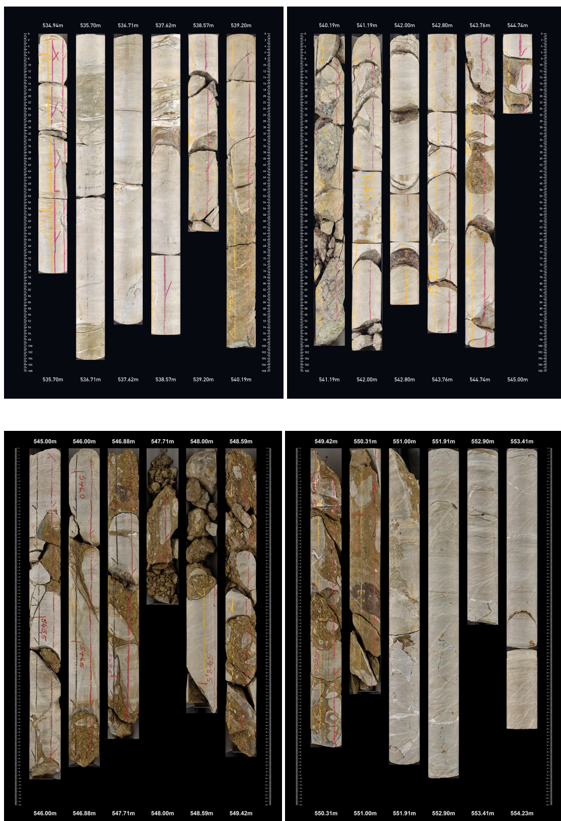
Fig. 4-6: Beispiel einer durch Verkarstungsprozesse überprägten Störungszone des Typs III aus BUL1-1
