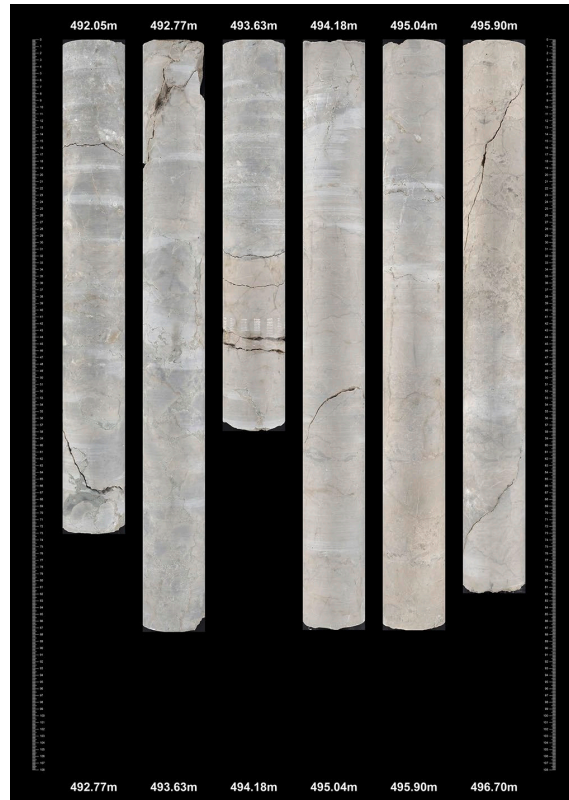
Fig. 3-4: Kernbeispiele aus STA3-1 der «Felsenkalke» + «Massenkalk»
