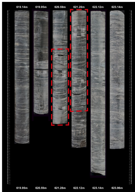
Fig. 4-7: Beispiele von in den TBO angefahrenen Störungszonen des Typ I in wenig kompetenten Gesteinseinheiten (MAR1-1 Bohrmeter 620.9 – 621.9)
