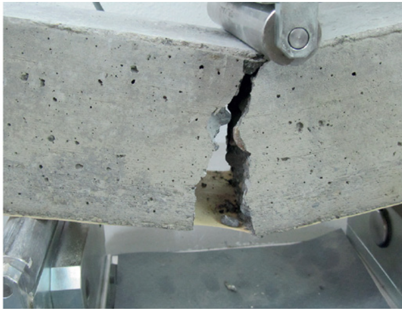
Fig. C-2: Rissversuch zur Prüfung von FPO-SikaProof® Abdichtungsbahnen
