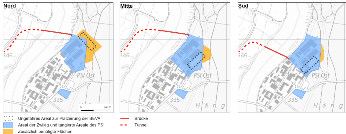
Fig. B-1: Darstellung der für die BEVA (schwarzes gepunktetes Rechteck) benötigten Flächen für die Konfigurationen Zwilag Nord, Mitte, Süd
