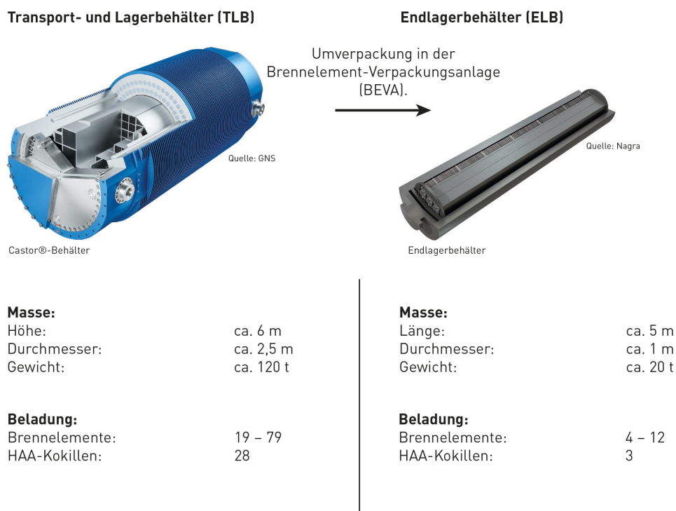
Fig. 1.1-1: Vergleich der Eigenschaften eines Transport- und Lagerbehälters (TLB, links) und eines Endlagerbehälters (ELB, rechts) inklusive entsprechender Beladung und Masse
