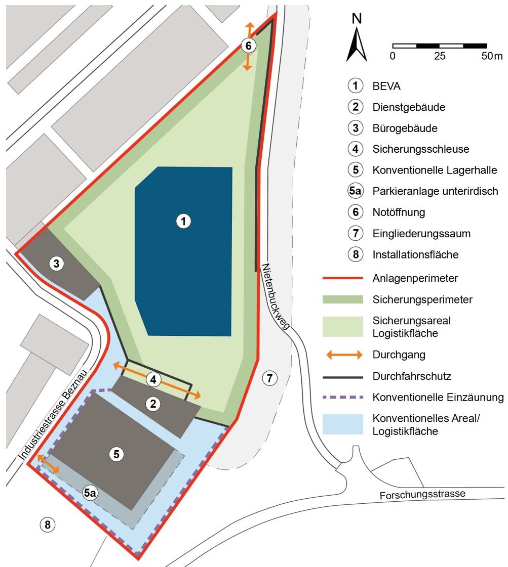
Fig. 3-2: Schematische Darstellung einer exemplarischen Anordnung der Bauten auf dem Anlagenperimeter
