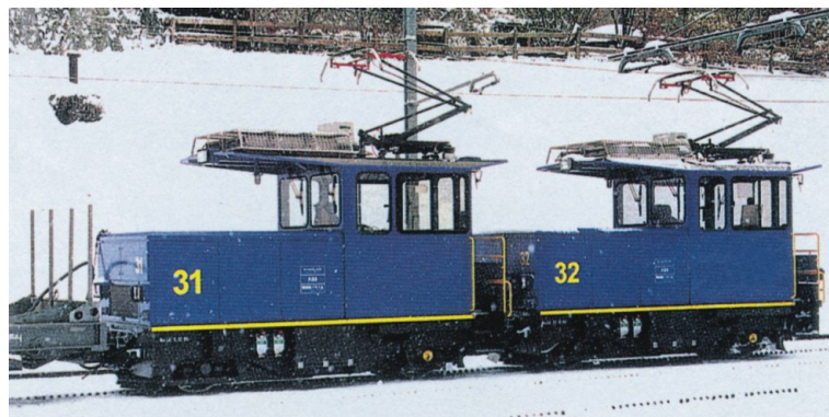
Fig. 5.4 Beispiel einer Zahnradlokomotive – Lokkonfiguration HGea 2/2 in Doppeltraktion
