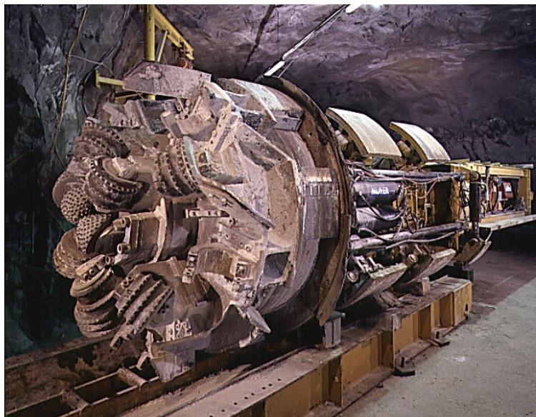
Fig. 4.2 Tunnelbohrmaschine wie sie z.B. zur Erstellung des FEBEX-Teststollens im Felslabor Grimsel eingesetzt wurde; Ausbruchdurchmesser 2.30 m
